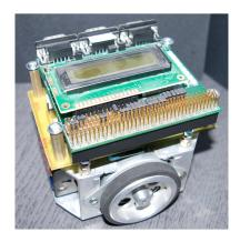
Fig. 6. Implementation of locomotion layer of flexible mini robot
