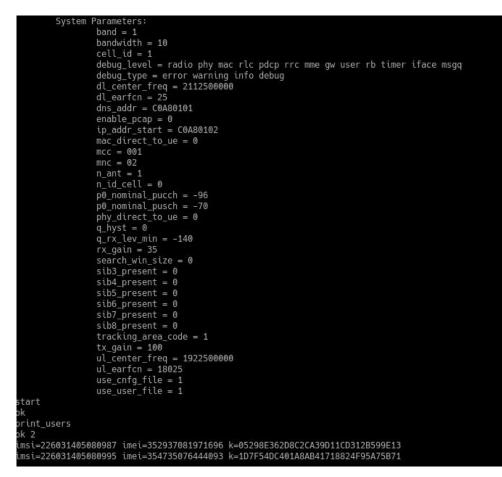
Fig. 2. USRP setup parameters
